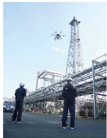
岡山事業所における定修中のドローン試行
