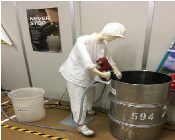
薬品移液作業
