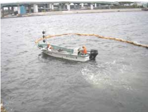
事故や災害で海面に油が流出した際にフェンスを張って拡散を防止する訓練
