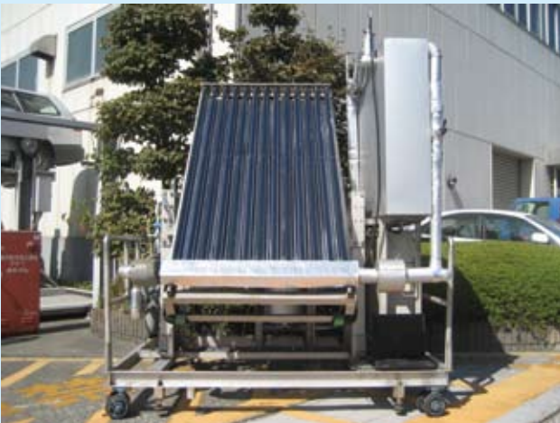
太陽熱回収性能試験
