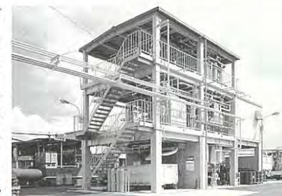
▲100%溶剤回収可能な廃塗料リサイクル装置
