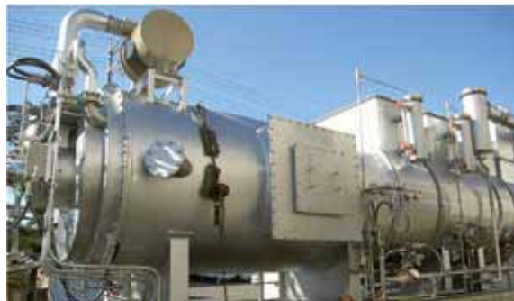
自製再生油を使用する廃液濃縮装置。同型の装置が2基あり、その外観から「トーマス」「パーシー」の愛称で呼んで親しんでいます。
