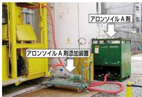
アロンソイル A 剤の製品形態 (環境にやさしいリターナブルコンテナを使用)
