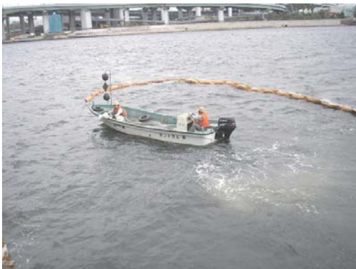
オイルフェンス展張訓練（セントラル硝子株堺工場沖） 事故や災害で海面に油が流出した際に拡散を防止し、海洋環境を守る訓練を行っています。
